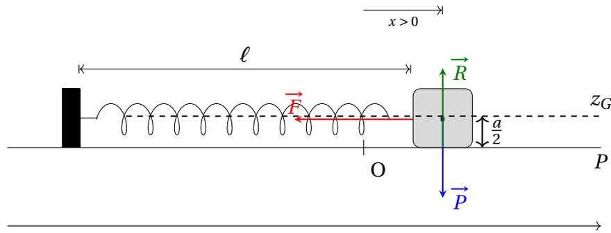
1.  $E_{pe} = \frac{1}{2}.k.x^2 + C$ , à la position d'équilibre  $E_{pe}(0) = 0 \Rightarrow C = 0 \Rightarrow E_{pe} = \frac{1}{2}.k.x^2$
