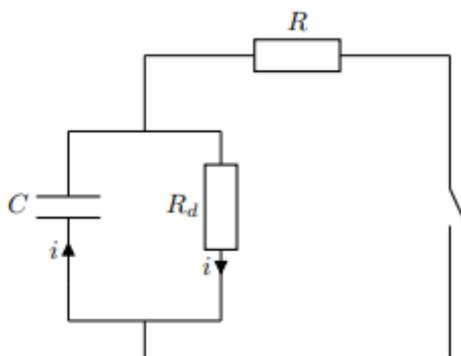
2.1. Lorsque l'interrupteur est ouvert implique que le courant ne traverse plus le conducteur ohmique de résistance  $R$ , le circuit fermé est celui qui contient le condensateur et la résistance de fuite  $R_d$ . Son équation différentielle est celle d'un circuit (RC) en série s'écrit sous la forme :
